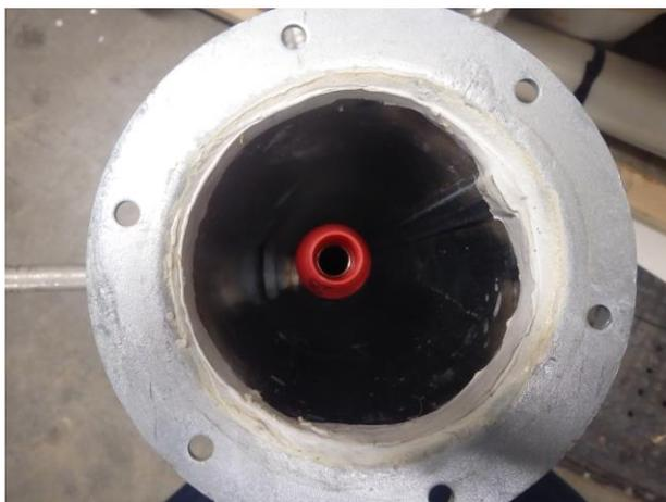
Figure 4. Buse d'échantillonnage du tunnel de vent
