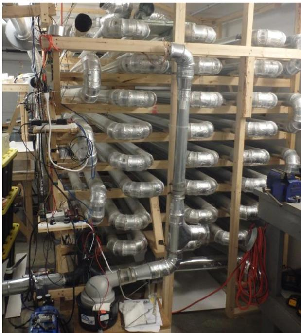
**Figure 5. Humidificateur sur le côté du tunnel avant son raccordement au tunnel**
