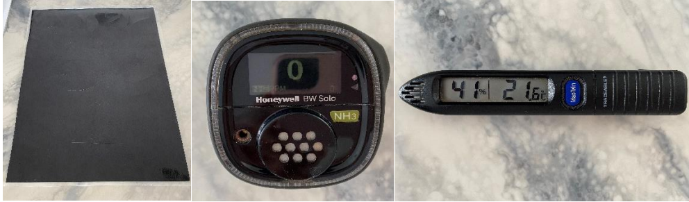
Figure 2. a) Feuille noire plastifiée utilisée pour l'évaluation des niveaux de poussières ; b) Détecteur d'ammoniac portatif ; c) Thermomètre et hygromètre traçable
