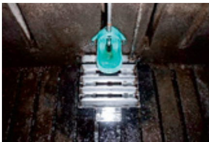
Figure 2 : Système conçu par le CDPQ pour quantifier l'utilisation de l'eau
