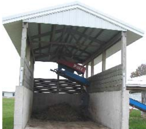
Figure 10 . Plate-forme d'entreposage temporaire des déjections solides et la montée de la chaîne à écurer
