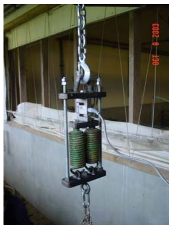
Figure 16 : Vue de l'ensemble de la cellule de charge
