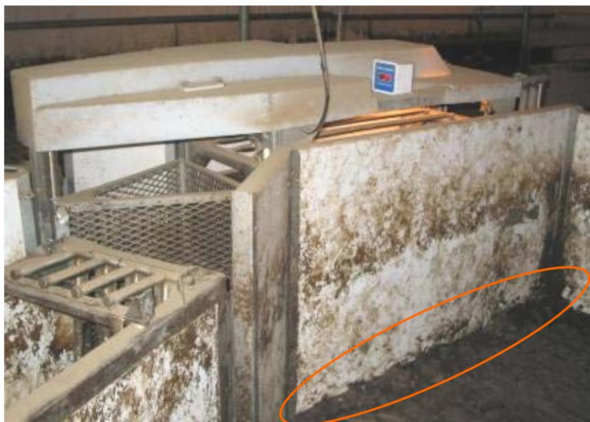
*Figure 5-21. Panneaux de protection de la balance en plastique plein jusqu'au sol*
