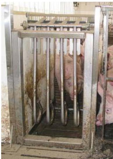
Figure 5-9. Barrière anti-retour avec doigts
