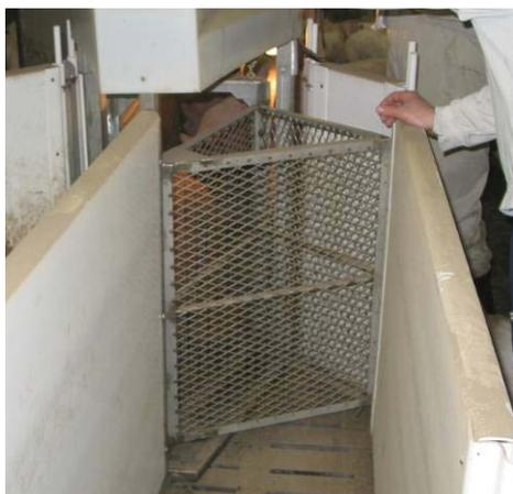
Figure 5-7. Porte de sortie de la balance grillagée
