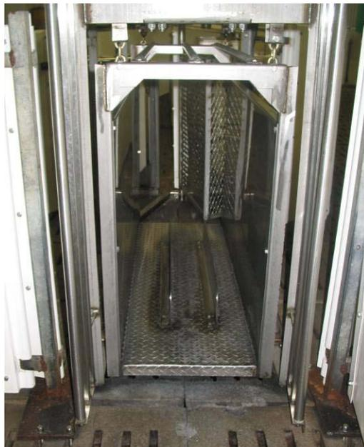
*Figure 5-6. Dispositif permettant d'éviter que les porcs se couchent dans la balance*
