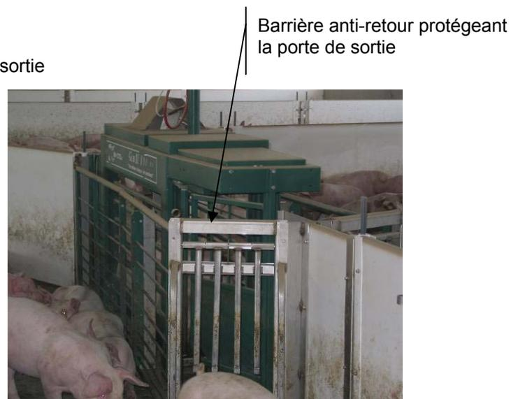
Figure 4-2. Station de tri à 2 voies et barrière anti-retour
