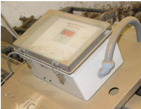
Figure 5-16. Module d'affichage de la balance
