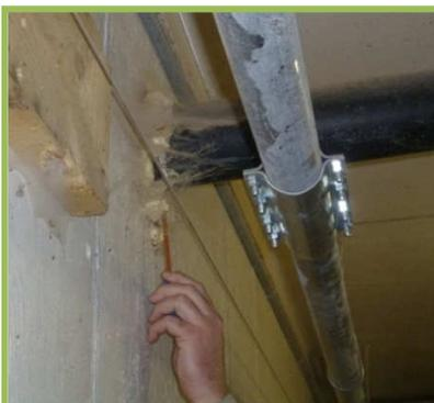
**Figure 20** Test de fumée effectué sur le pourtour d'une conduite d'alimentation en moulée étanchée avec de la mousse permettant de voir qu'une infiltration d'air est possible
