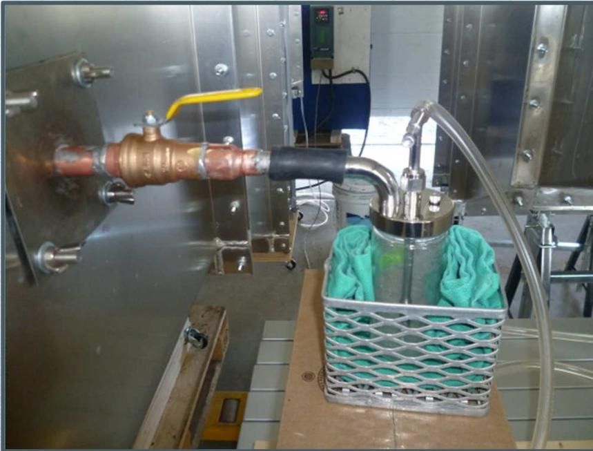
Dispositif expérimental pour la nébulisation des aérosols viraux
