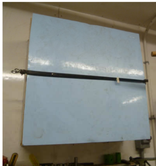
Figure 40 Panneau de styromousse plastifié muni d'un coupe-froid en caoutchouc appuyé sur un cadre en bois à l'aide d'une courroie élastique
