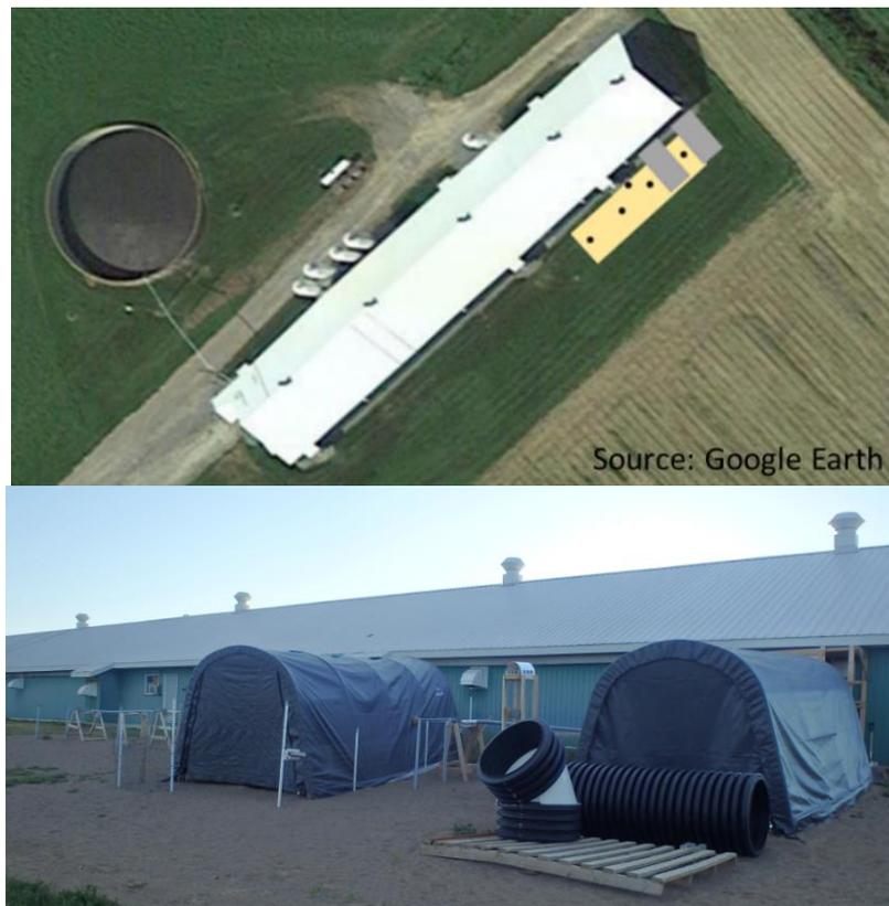
**Figure 10** *Reproduction de la tranchée de sable (rectangle couleur pêche), des deux abris autos (rectangles gris) et des sections d'instrumentation (points noirs) à la Station de Deschambault*
