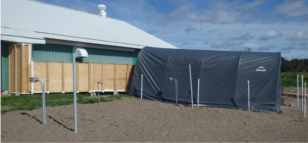
*Figure 30 Abri auto visant de concentrer l'air au-dessus de la tranchée du puits de captation*
