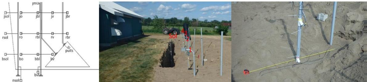
Figure 18 Emplacement des sections d'instrumentation dans la tranchée et localisation des sondes de température sur chaque section
