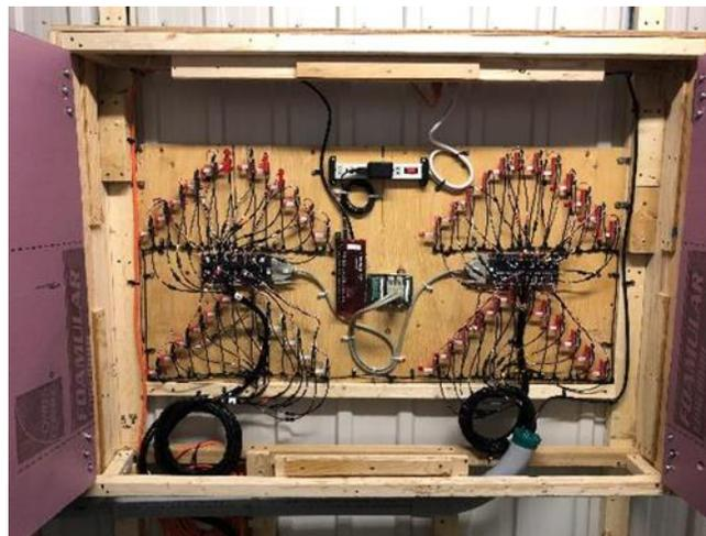
Figure 22 Panneau d'acquisition des données de pression
