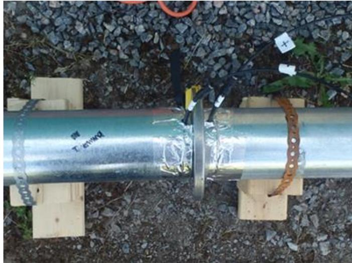
Figure 6 Iris 4 po à un ajustement de 3
